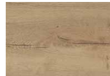
L1 HRASST GRČA PUKOTINA
